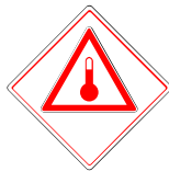
Marque pour les matières transportées à chaud
