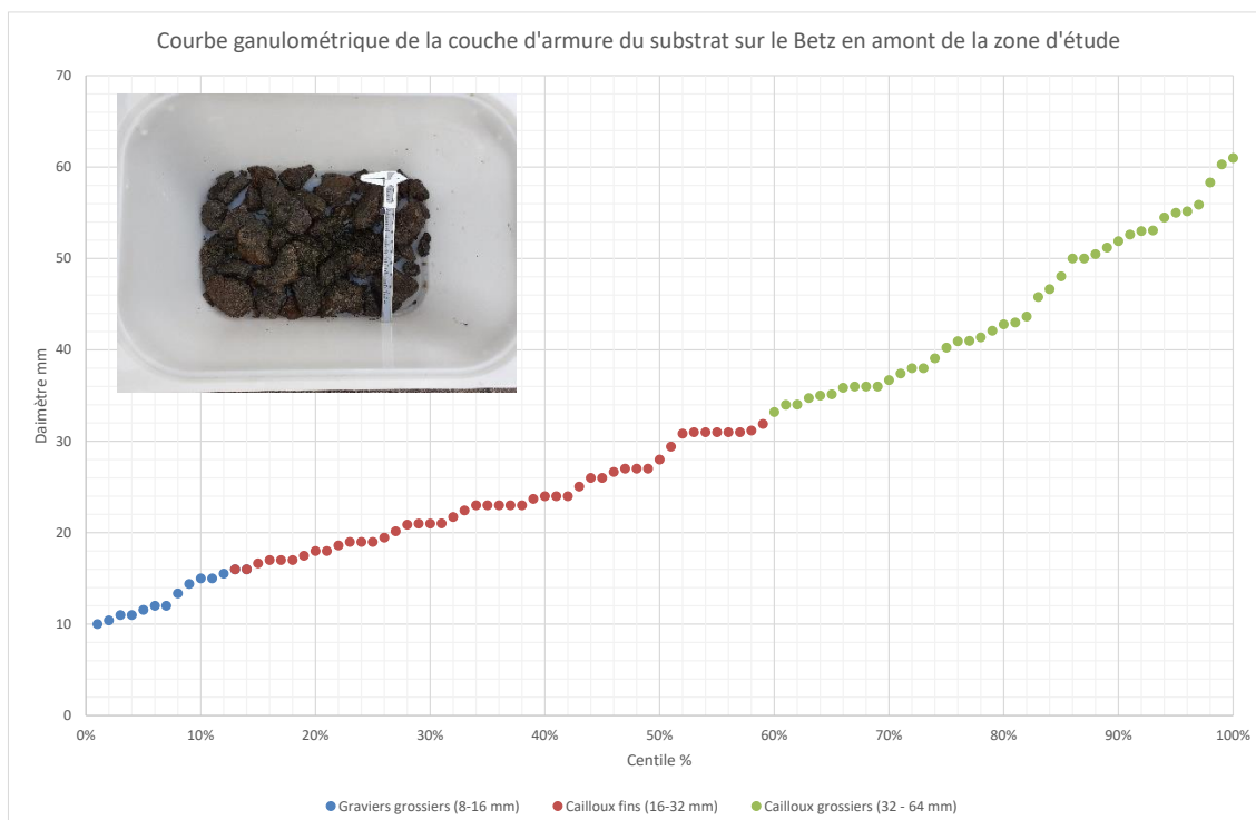
Figure 10 : Courbe granulométrique (en nombre d'éléments et non en poids) représentative de la couche d'armure des alluvions présentes sur les portions d'écoulements courantes du Betz
