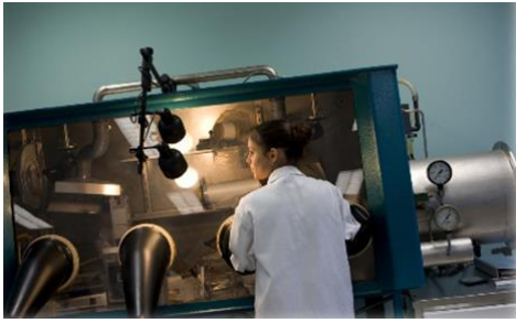
Photographies : préparation et examens post mortem de batteries (démontage et conditionnement en boîte à gants, Tomographie X cellule batteries, microscopie électronique sur section d'électrode)
