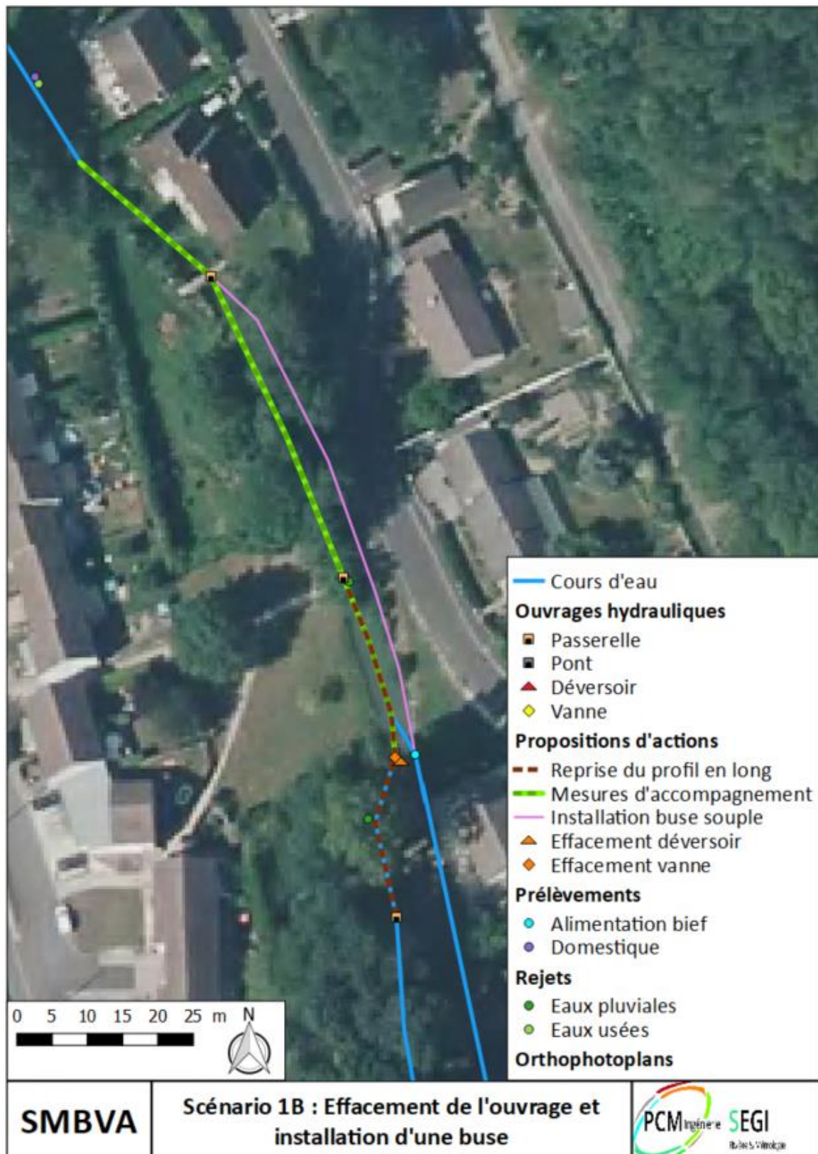
Figure 2 : Schéma de principe des aménagements prévus au droit de l'OH1
