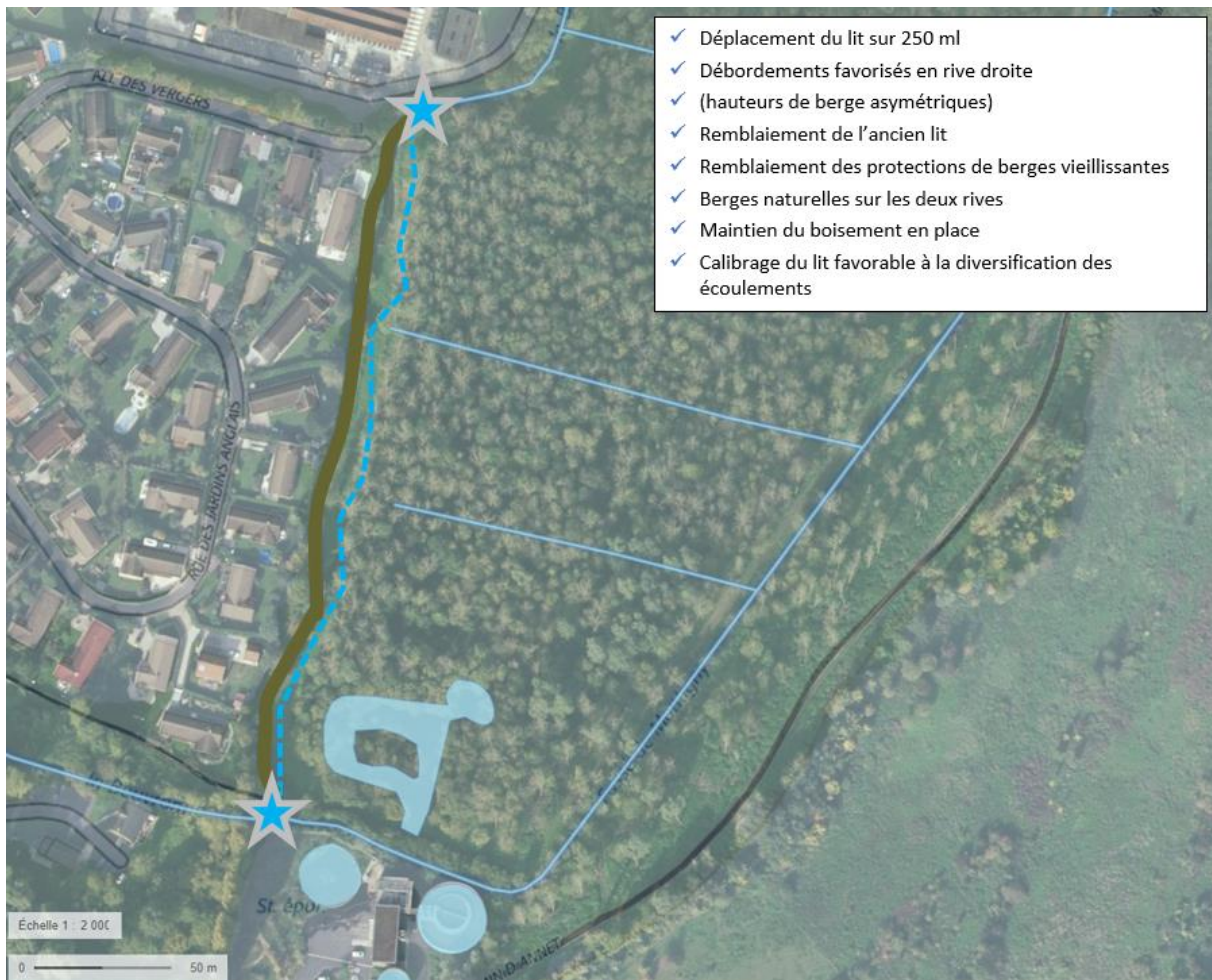
Figure 6 : Modification schématique du lit de la Beuvronne
