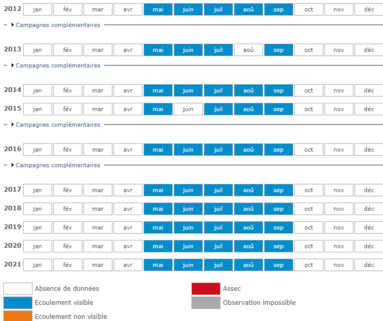
Figure 6 : Résultats de la campagne d'observation des écoulements du Betz à la station de Bransles (77). Période 2012 à 2021. (source : Observatoire national des étiages).
