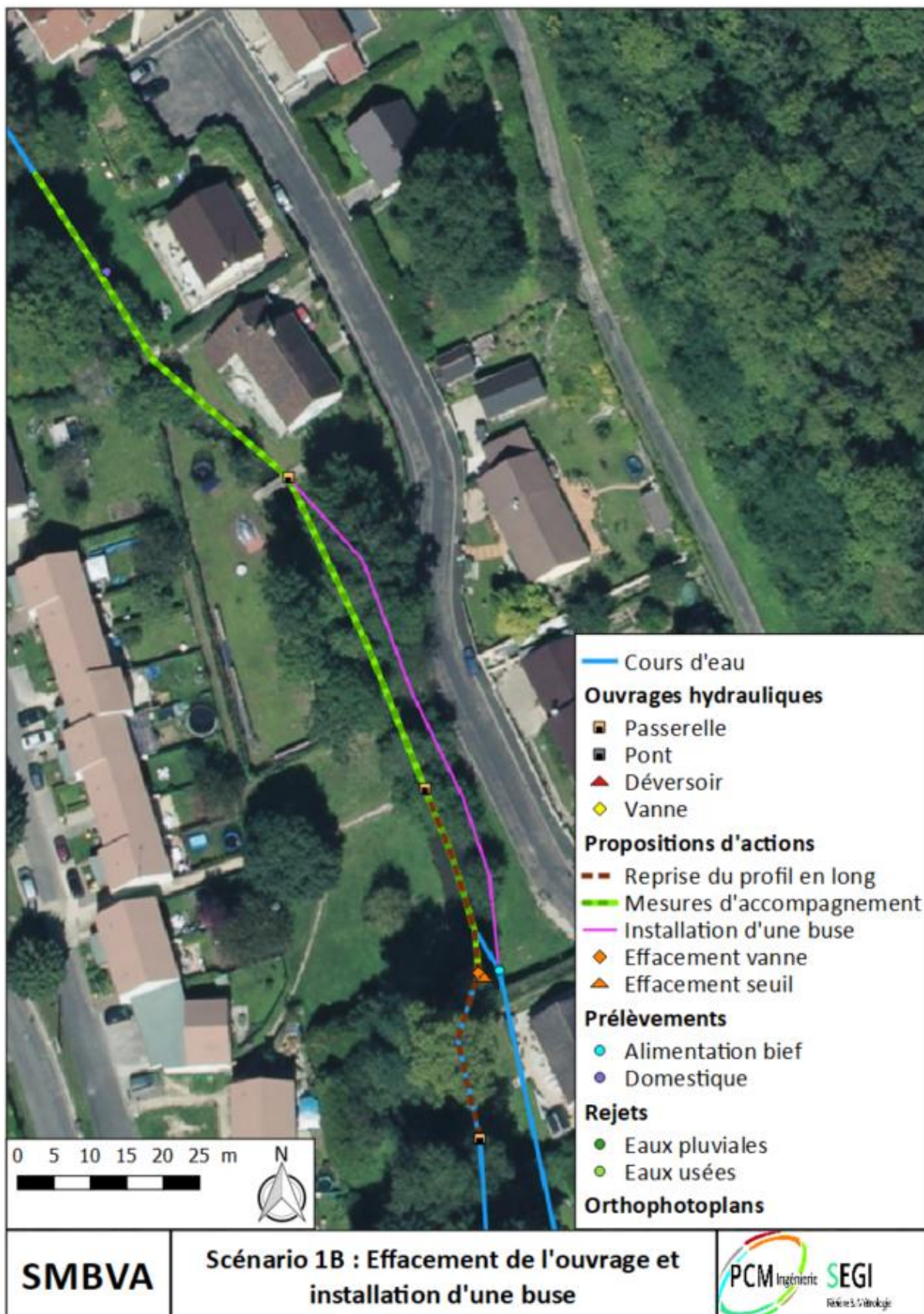
Figure 8 : Schéma de principe des aménagements prévus au droit de l'OH1
