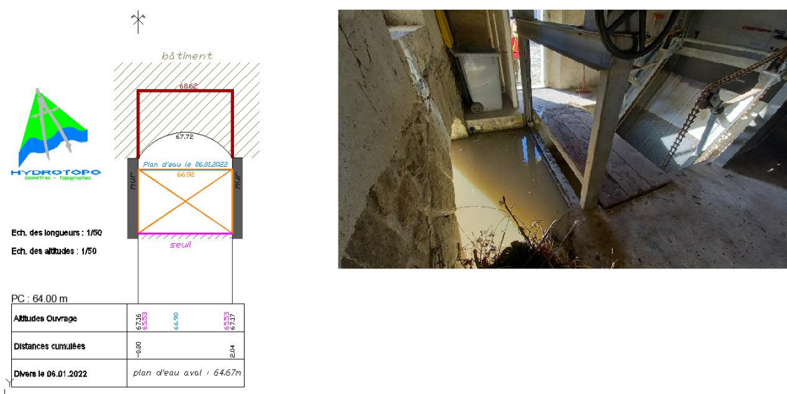
Figure 7-14. Vue en coupe de la vanne usinière du moulin de Nonville (OH36)
