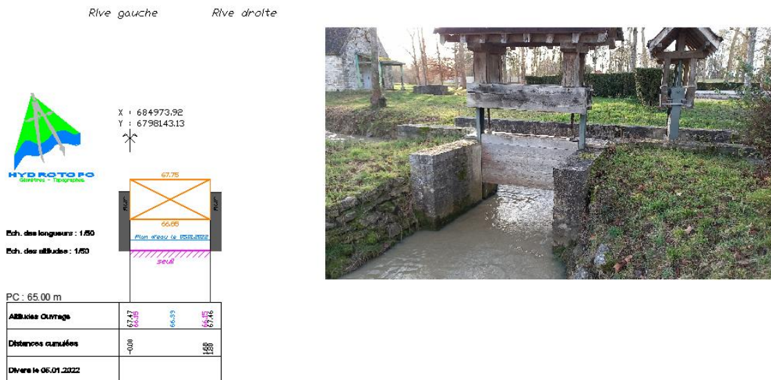
Figure 7-16. Vue en coupe de la vanne OH5 desservant le bras inférieur du Lunain
