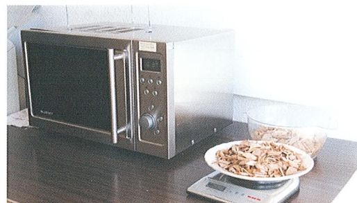
Contrôle de l'humidité du combustible (balance et micro-ondes)
